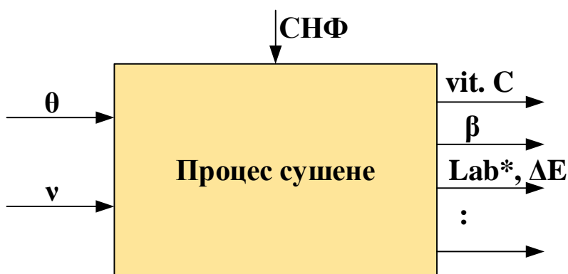
фиг. 3. Кибернетичен модел на многофакторния експеримент преставащ процеса на сушене на плодове
